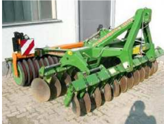
Abbildung 5: Scheibenegge zur Stoppelbearbeitung (Klik et al., 2008)
