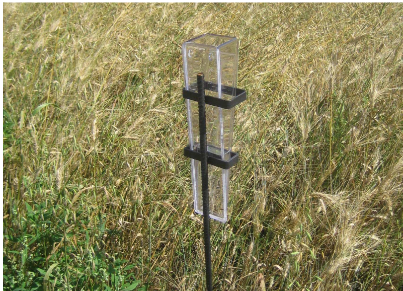
Abbildung 16: Erfassung der Niederschläge mittels Regenmesser
